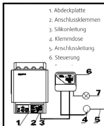
Abbildung 6.5: Anschlussplan
